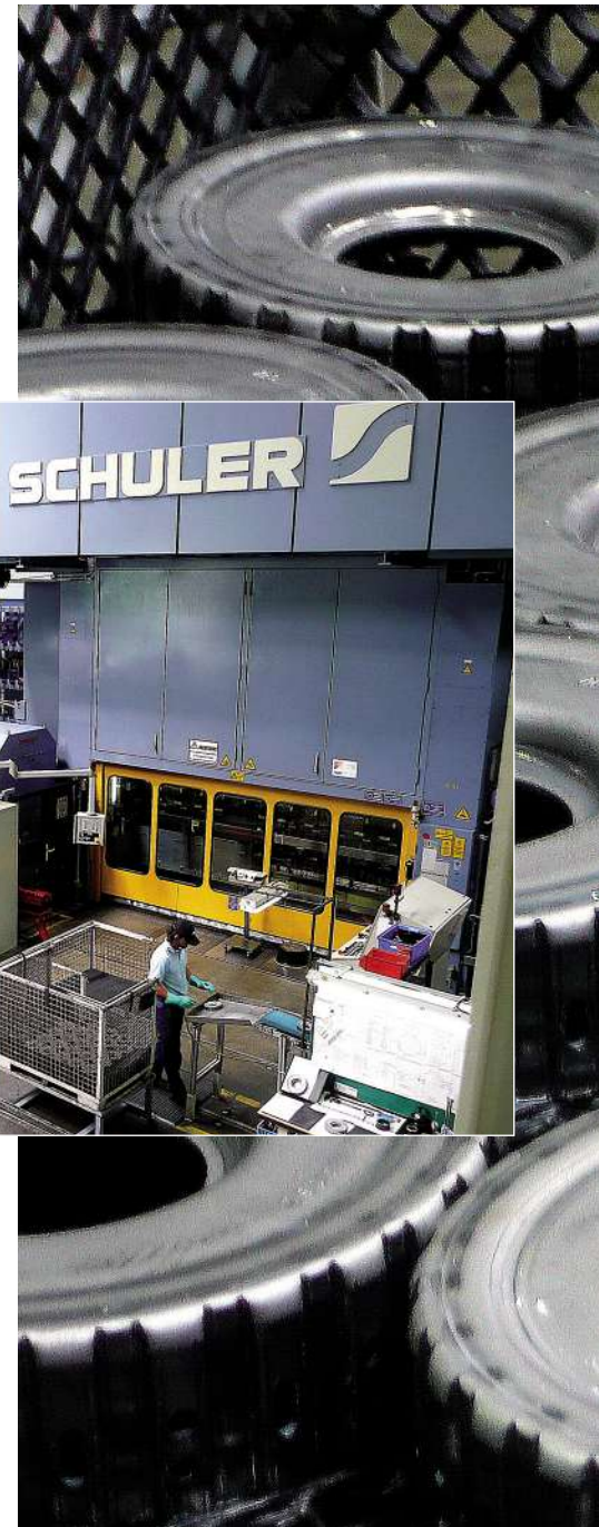
Arrangement des Dreher-Equipments um die bestehende Mehrstufenpresse, auf der die hochpräzisen Getriebeteile produziert werden. Das Band wird vom Coil abgewickelt und der Presse quer zugeführt.
